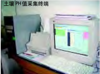
数据采集终端: 将计算机串口 (RS232 接口) 与土壤测试仪器的输出端口连接, 使测试数据直接在计算机中读出。
