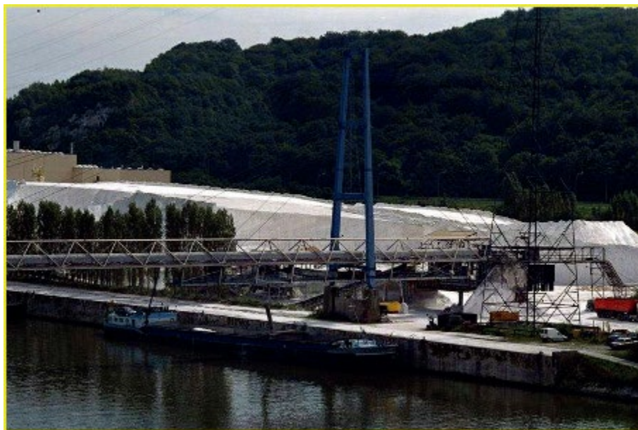
图 77. 横跨默兹河的半水合物型磷石膏输送机（图片由普瑞昂集团提供）
