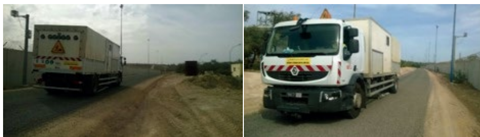
图 107. 使用偏转仪对道路性能（承重和抗压强度）进行测量（图片由 OCP 提供）
