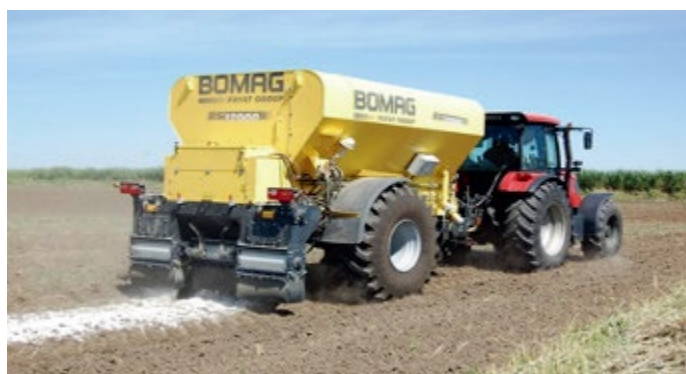
图 26. 使用散装物料撒布机 BOMAG BS12000 撒布磷石膏（图片由欧洲化学公司提供）
