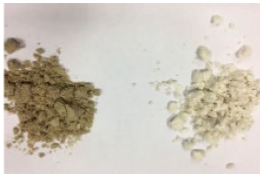
图 80. 天然半水合物型磷石膏(左)以及经处理后变成的 PureGyp 磷石膏(右)(图片由 Carbon Cycle 提供)
