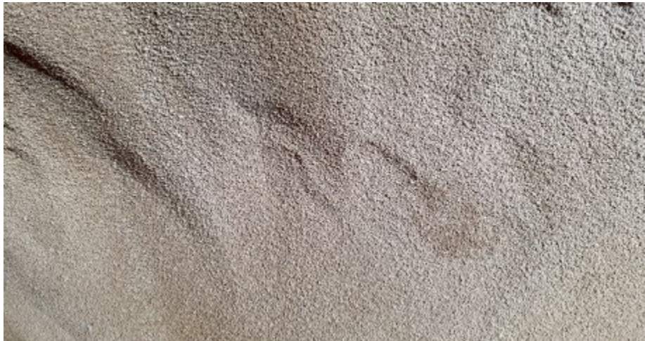
图 116. 造粒后的混合粉末（Zypmite）（图片由阿莱夫集团提供）
