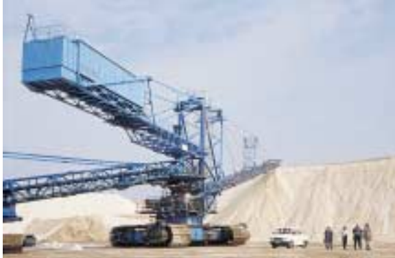
Stacking salt tailings - Kali und Salz GmbH, Zielitz, Germany
