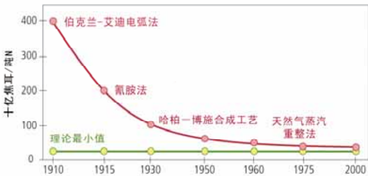
图14. 合成氨装置的设计能耗变化趋势（摘自Anundskas, 2000）
