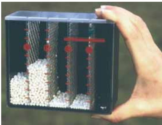
图片 5. 通过尺寸测量仪检测颗粒尺寸控制情况 （提供：Sulky-Burel）
