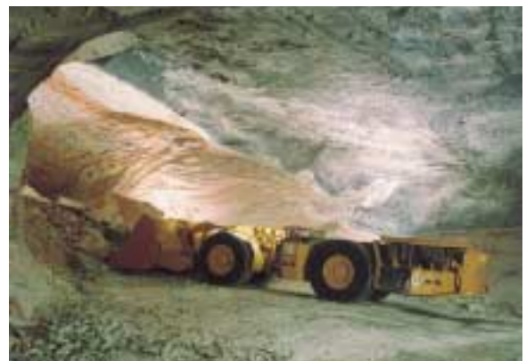
Loader (LHD-Load, hold, dump unit) - Kali und Salz GmbH, Germany
